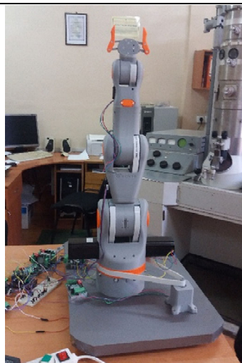
Рис. 12 Загальний вигляд діючого робота-маніпулятора Moveo, який впроваджено на кафедрі ТОМВ ЧДТУ в навчальний процес підготовки фахівців за спеціальністю G9 «Прикладна механіка»
