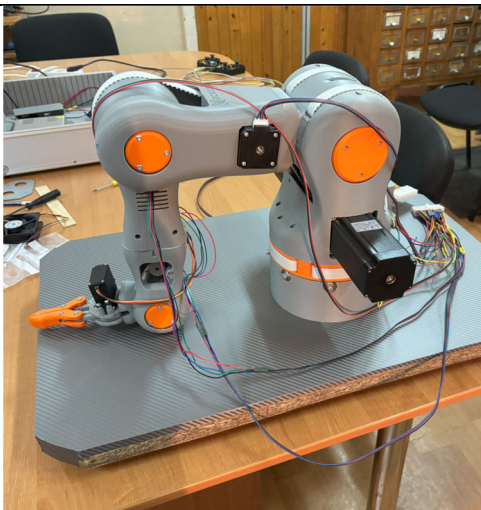
Рис. 11 Відображення опори і механічних вузлів (вузли позначені помаранчевим кольором) виготовленого робота-маніпулятора Moveo
